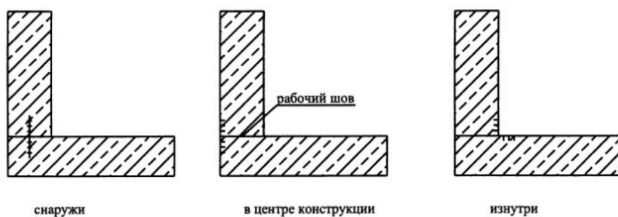
Рис. 4.8. Разные способы уплотнения стыков
